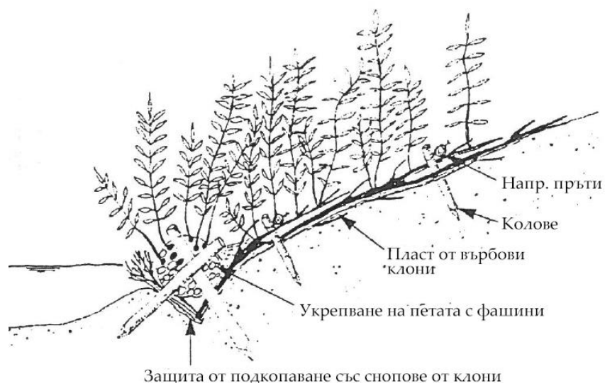
Фигура 4.28 Пласт от върбови клони с укрепване на петата от фашины и защита от подравяне от снопове клони (4)
