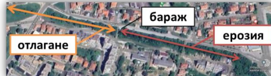
Ерозия на дъното и свличане на десен бряг при заустване на канализационен колектор след преминаване на високи води Източник на изображението: личен архив 02.2021 г.
