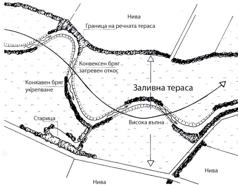
Фигура 12 Оформяне на речното корито в план – трасиране, укрепване и осигуряване на път на високата вълна (18)
