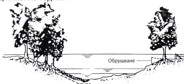
Фигура 15 Оформяне на коритото в напречен профил в крива (18)
